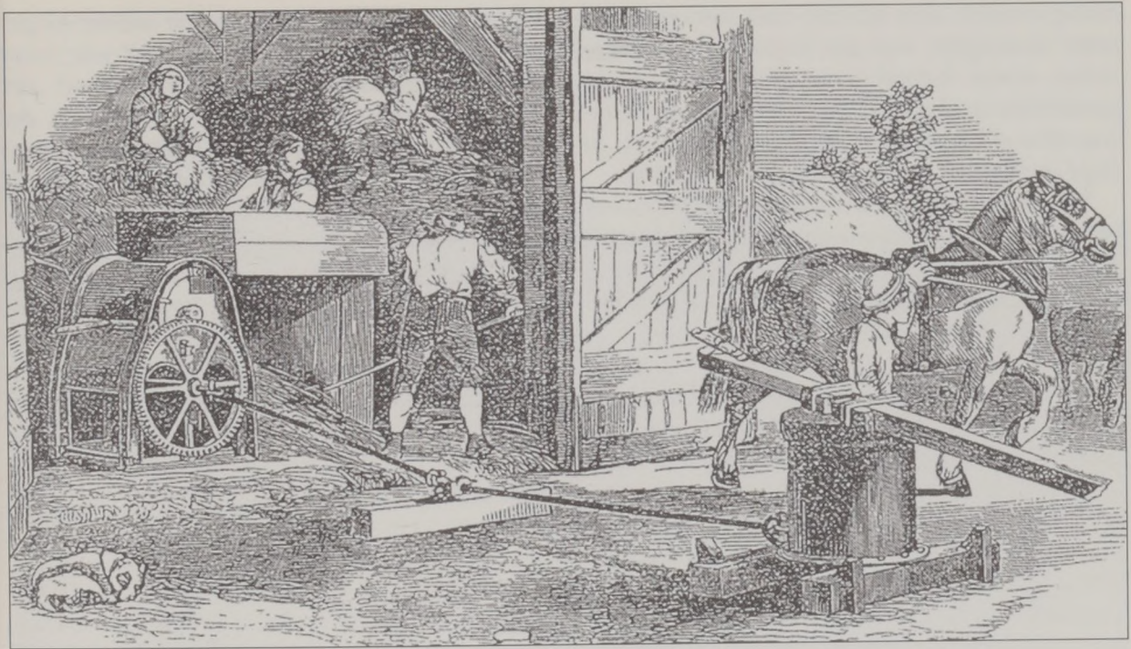
Baretsche Dreschmaschine mit Zylindergöpel nach Wilhelm Hamm (1870).
