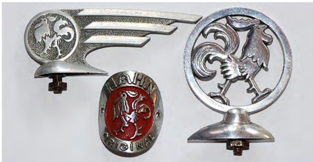
Schutzblechembleme und Steuerkopfzeichen der Firma Hahn.
