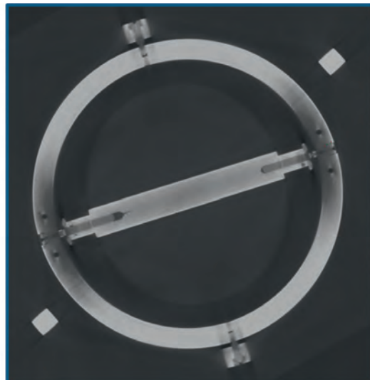
Eine Röntgenaufnahme der Rotorlagerung des zweiten Originals verdeutlicht Buzengeigers Fertigkeit als Feinmechaniker. Die Halteschrauben des Rotors links und rechts haben einen Durchmesser von 1,6 mm und nehmen noch eine Innerbohrung von 0,8 mm Durchmesser auf!
