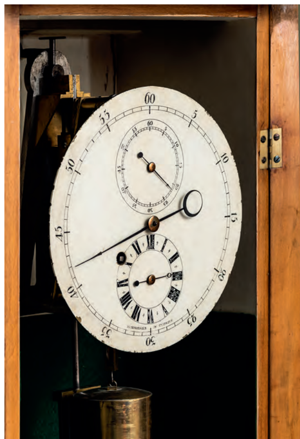
Standuhr von Gottlob Buzengeiger an der Universität Tübingen. Die Aufteilung des Zifferblatts mit dem großen Sekundenzeiger entspricht der damaligen Nutzung für naturwissenschaftliche Zwecke.
