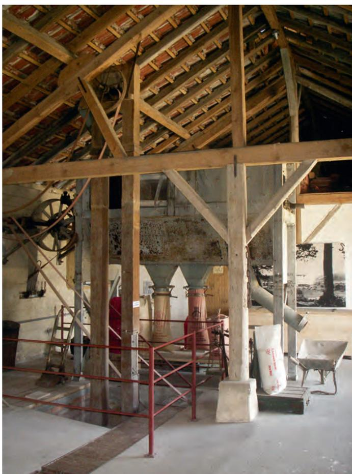
*Die voll funktionsfähige Sieb- und Abfüllanlage, die über einen 5-PS-Benzin-Motor, Transmission und Förderschnecke betrieben wird.*
