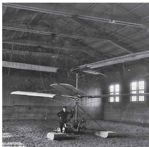
Ludwig Rüb beschäftigte sich sogar mit dem Bau eines Hubschraubers. Der Prototyp wurde verwirklicht, stieg aber leider nie in die Luft. Auf dem Foto von 1916 ist das Gerät in der Versuchsanstalt in Stuttgart zu sehen.
