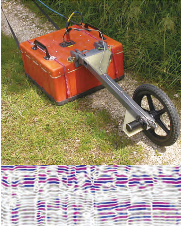
Bodenradar-Untersuchungen helfen bei der Suche nach geeigneten Grabungsstellen. In dem roten Kasten, der über den Boden gezogen wird, befinden sich Sender und Empfänger für die Radarwellen. Unten: Das Ergebnis! Die einzelnen horizontalen Linien zeigen Reflektoren im Untergrund, z. B. Schichtflächen; dadurch können gestörte und ungestörte Schichtverbände unterschieden werden.
