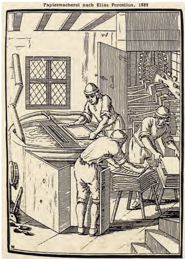
«Der Papierer», Holzschnitt von 1689. Arbeit des Papierschöpfers, des Gautschers («Entwässerer») und Legers, im Hintergrund die Nockenwelle mit den Stampfhämmern.
