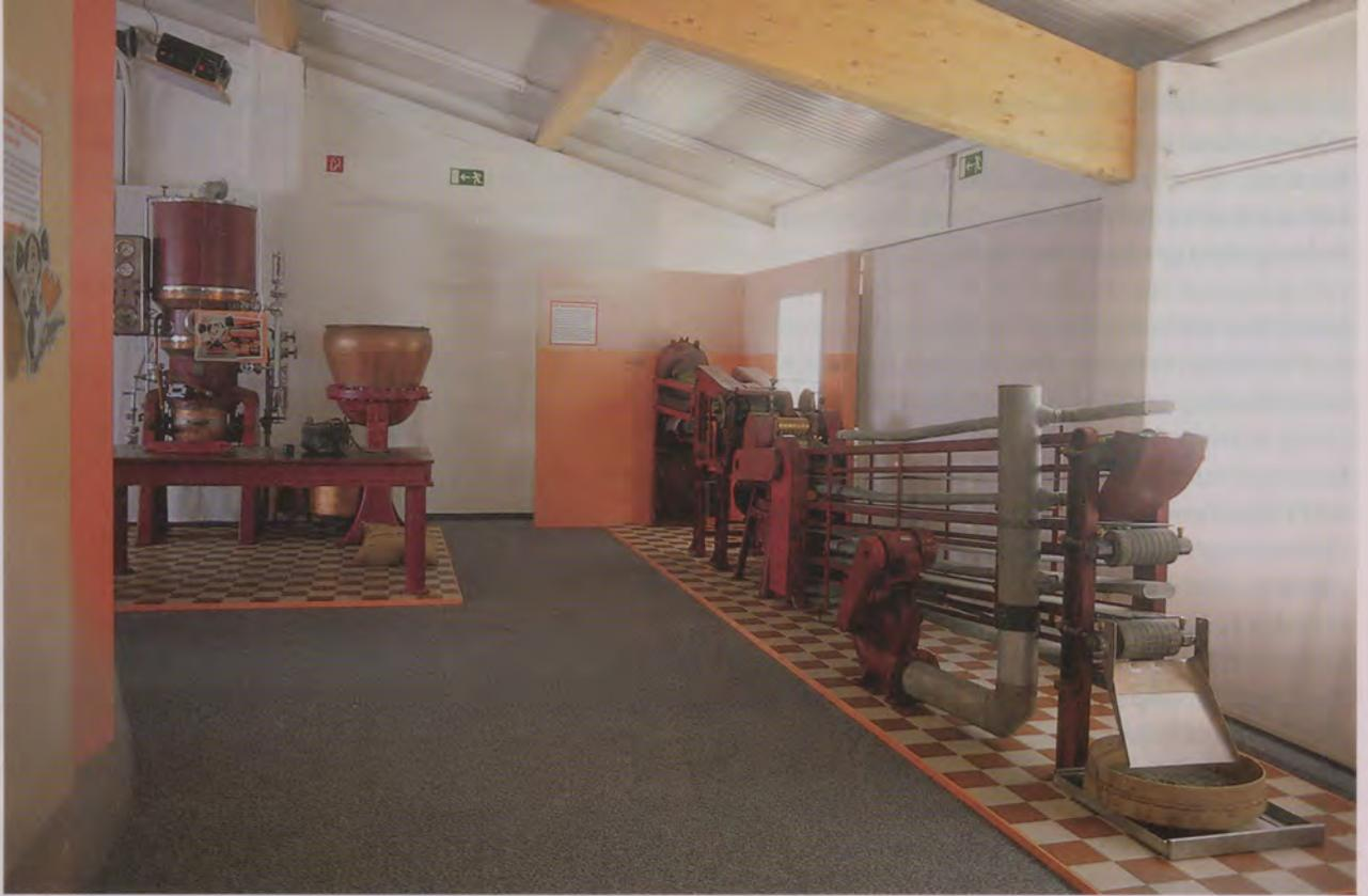
Bonbonmaschinen von einst im Kleinglattbacher Bonbonmuseum: ein Kessel für die Bonbonmasse sowie Kühltisch, Kegelroller, Prägemaschine und Kühlband.
