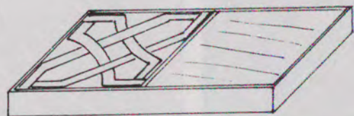
3. Der getrocknete Rohling wird aus der Holzform gekippt und gebrannt.
