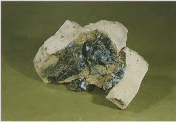
Bruchstück eines Schmelztiegels mit Resten der erstarrten Glasmasse.
