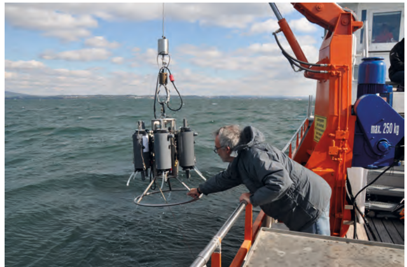
Das mit Wasserproben gefüllte Probenahmegerät wird an Bord geholt.
