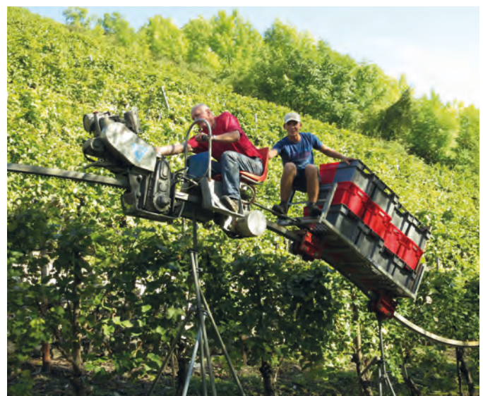
Einschienen-Zahnradbahn (auch Monorackbahn) für den Transport von Personen, Lesegut und Arbeitsgerät
