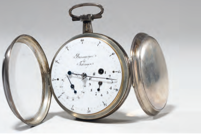
Vorder- und Rückseite der «Secundenuhr» für die Universität Würzburg – eine simple Stoppuhr zur Messung der Dauer der Pendelbewegung des Reversionspendels.
