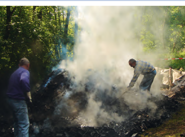
Wenn das Holz vollständig zu Kohle verschwelt ist, ziehen die Köhler den Meiler auseinander und lassen die Holzkohle kontrolliert abkühlen.
