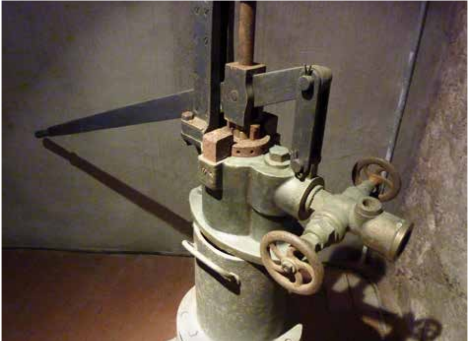
Abb. 3 - Krauß' Abdrückpumpe aus dem Wassermuseum im ehemaligen Seelhausbrunnenwerk (Foto: Burckhard Pichon).
