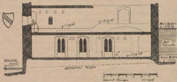
Abb. 6. Schnitt durch das Sulmeisterhaus. (Unter Verwendung von A. Haugs Zeichnung in W. Hommels „Schwäbisch Hall“, S. 181.)
