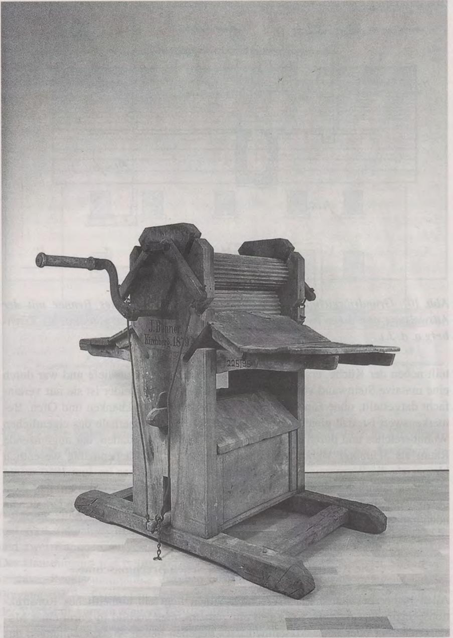
Abb. 11 Die mit drei gezahnten Walzen ausgestattete Flachsbrechmaschine aus Dörmenz in der Werkstatt des Restaurators (Foto: Volker Immel, Ilshofen).
