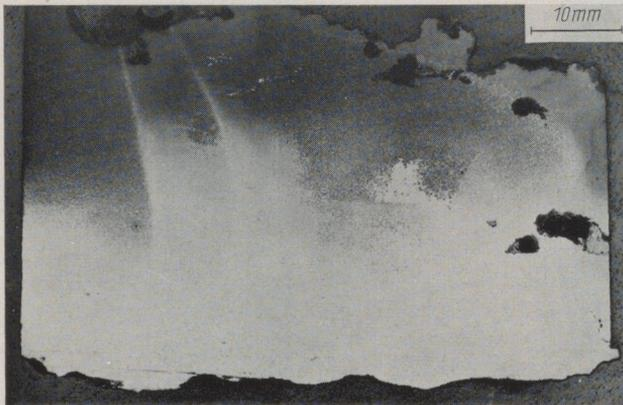
Bild 3. Makrogefüge im Klingenteil des Langsax (alkohol.  $\text{HNO}_3$ ) (rd. 1,2 : 1, Original 2 : 1).
