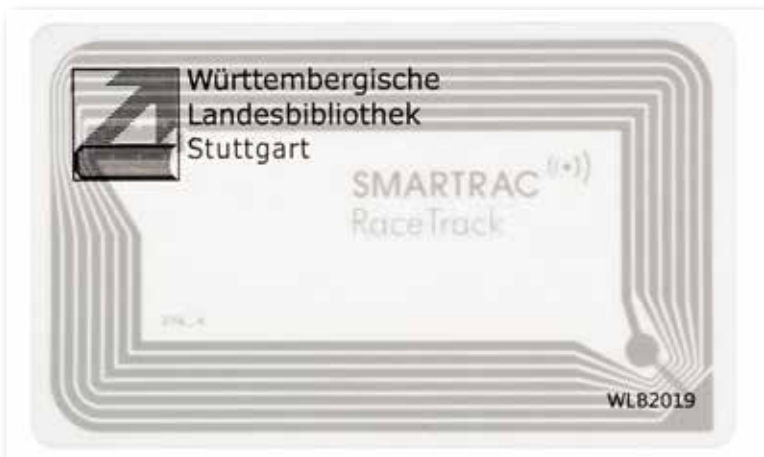
Abb. 1: RFID-Etikett, fotografiert als Durchlichtaufnahme
