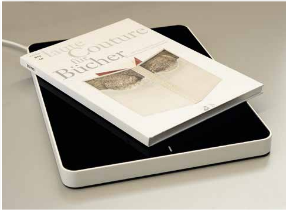
Abb. 2: RFID-Antenne mit integrierter Leseelektronik
