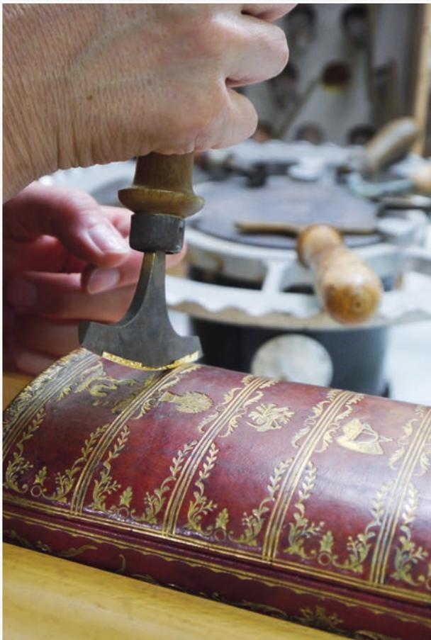
Abb. 2: Goldprägung. Im Hintergrund werden die Werkzeuge zum Prägen erhitzt.
